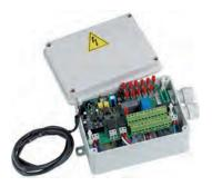
Centralina base 6T Sistema elettronico per teste elettrotermiche
